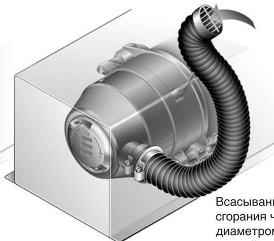
Всасывания воздуха для сгорания через гибкий шланг диаметром  $\varnothing$  60 мм и длиной в 1 м.
